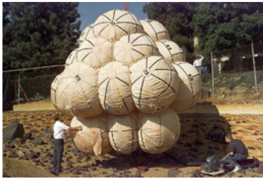
图6. “火星探路者”项目中使用的缓冲气囊
