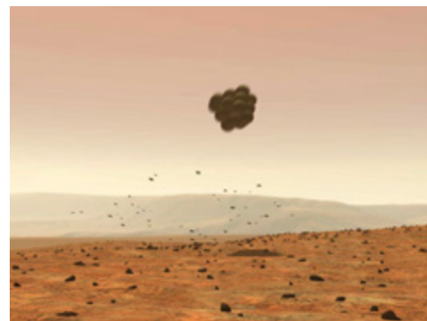
图11. 装有“机遇”号火星车的四面体型着陆器弹跳着陆
